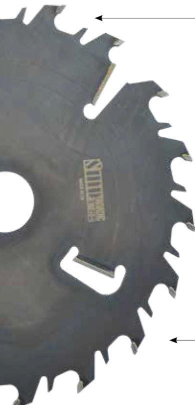
Корпус пилы, имеющий твердость 48 HRC, изготовлен из специальной запатентованной стали разработанной совместно заводом Walter и производителем стали Risse+Wilke (Германия) легко поддается проковке и не встречается у других производителей пил.
